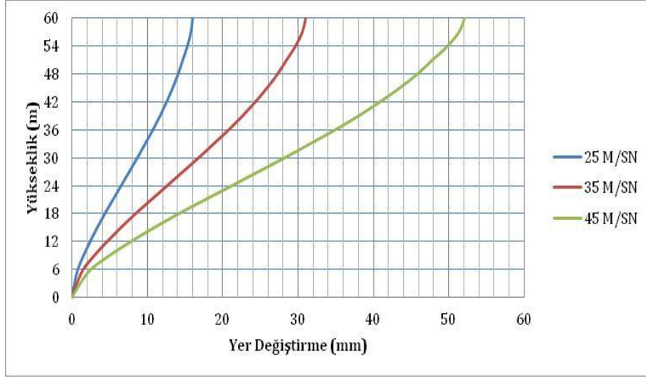
Şekil 4.76. 60 m K tipi eğimli 3 m aralıklı model (model 9) rüzgar hızlarına göre yükseklik-yerdeğiştirme ilişkisi
