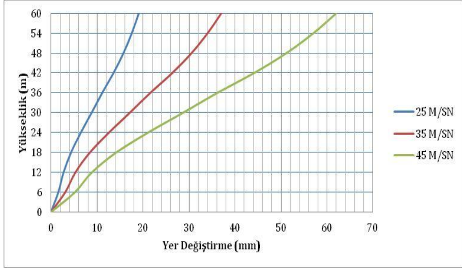
Şekil 4.70. 60 m ters V tipi eğimli model (model 7) rüzgar hızlarına göre yükseklik -yerdeğiştirme ilişkisi
