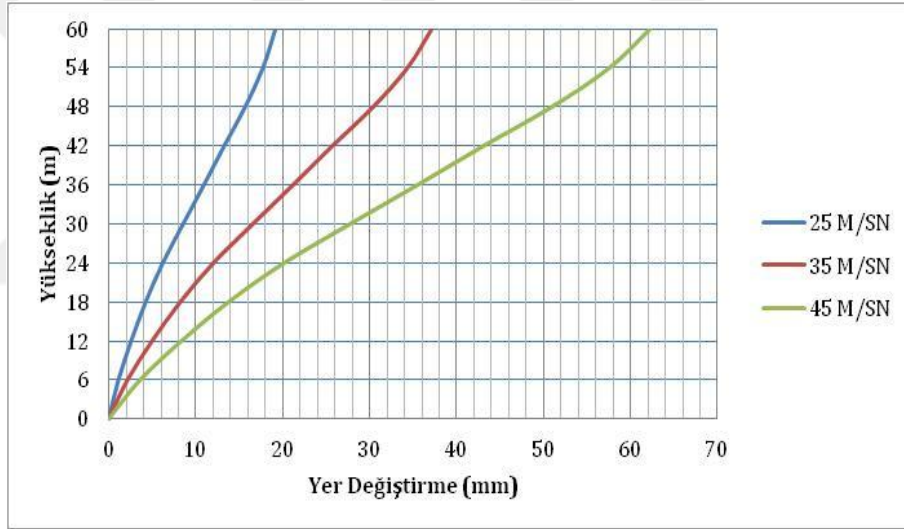
Şekil 4.85. 60 m X tipi eğimli model (model 12) rüzgar hızlarına göre yükseklik-yerdeğiştirme ilişkisi
