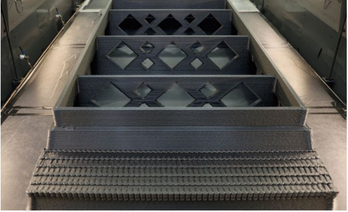
Şekil 3.9 Prekast betonların yapımında kullanılan, üç boyutlu basılmış kalıp örnekleri [82]
