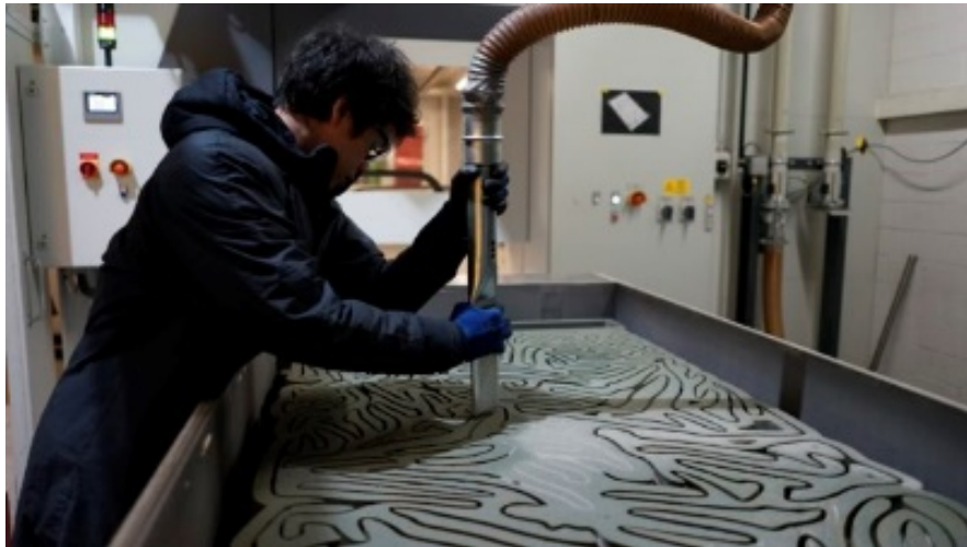
Şekil 3.11 Üç boyutlu basılan kalıba eriyik haldeki metalin dökümü [84]
