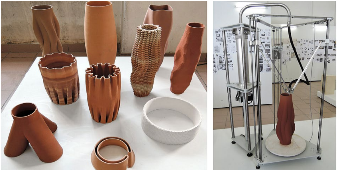
Şekil 2.37 Üç boyutlu baskı tekniğiyle basılmış seramik ürünler (solda) üç boyutlu basımı (sağda) [43]
