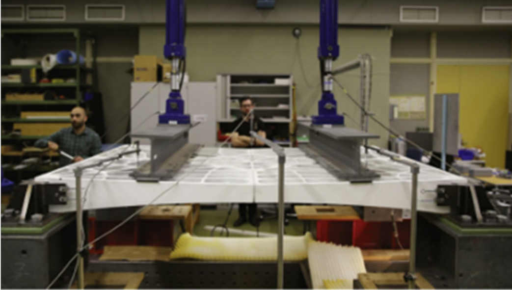
Şekil 3.4 Beton paneller üzerinde yük testi yapılması [74]
