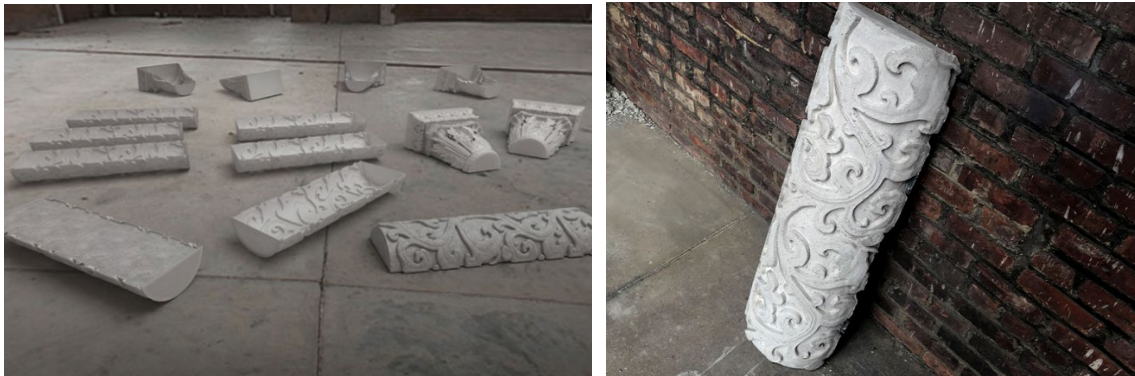
Şekil 3.47 Üç boyutlu yazıcıdan basılan kalıplar (solda) ve kalıplardan oluşturulan beton cephe süsleme elemanı (sağda) [112]
