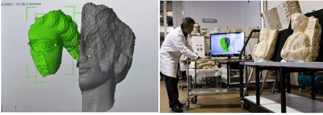
Şekil 3.68 Suriye / Antik Kent Palmira'da üç boyutlu baskı tekniğiyle restorasyonu yapılan heykellerin dijital ortama aktarılması [126]
