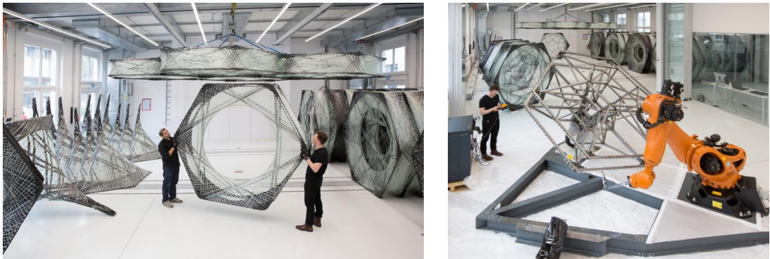
Şekil 3.24 Karbon fiber bileşiminden ötürü oldukça hafif olan ve boyutlarına rağmen elle kaldırılabilen altıgen elemanlar Londra'da bir araya getirilmeden önce, Stuttgart'taki bir laboratuvarında hücreler üretilmesi [94]
