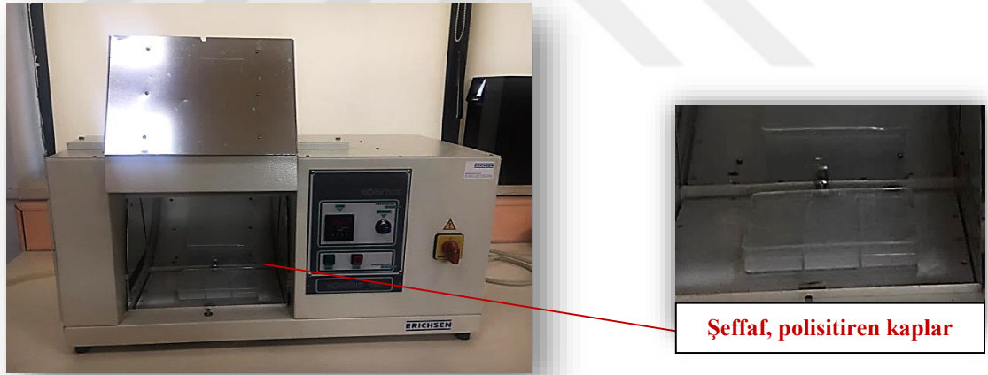
Şekil 4. 8 Erichsen Solar Box,1500 model ışınlama ünitesi ve çözeltilerin konulduğu ışınlama kapları
