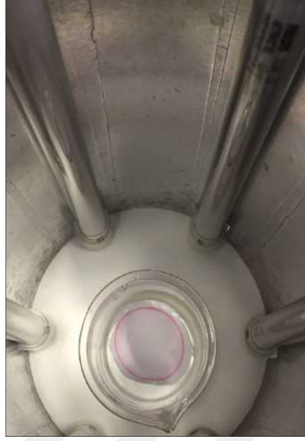
Şekil 3.5: UV Işın İçerisinde Membran Yerleştirilmesi.
