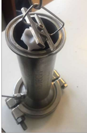
Şekil 3.3: Ölü Uç Membran Filtrasyonu / Sterlitech HP4750.
