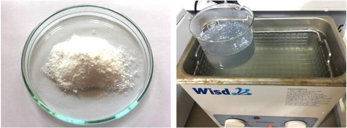
Şekil 3.2. SiO 2 Nanoparikülü ve ultrasonik banyoda sonifikasyonu (Özgün )
