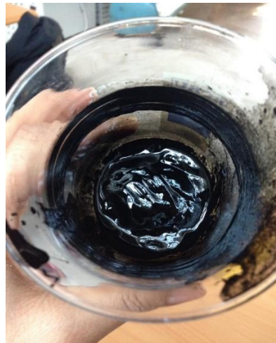
Şekil 3.21 MWCNT-su (%0,7, hacimsel) nanoakışkanının çökelme testleri
