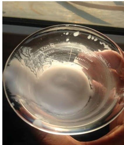
Şekil 3.20 \text{Al}_2\text{O}_3 -su (%1,26, hacimsel) nanoakışkanının çökelme testi
