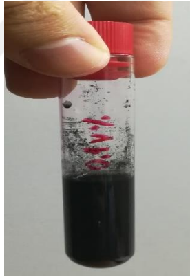
Şekil 3.22 MWCNT-su (%0,07, hacimsel) nanoakışkanının çökelme testleri
