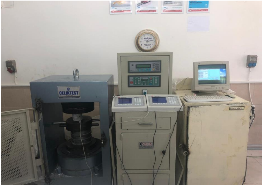
Şekil 3.9. Basınç Dayanımı Deneyi
