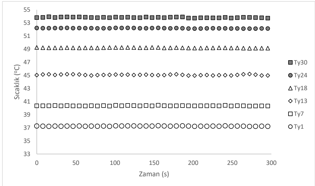
Şekil 3.14 : B5 deneyinin ( q_{\text{ort}} = 106 \text{ W} , \bar{m}_{\text{ort}} = 4.5 \text{ g/s} , f_m = 3.30 \text{ Hz} ) yüzey sıcaklıklarının zamana bağlı eğrileri.
