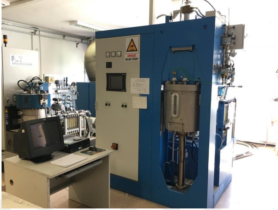
Görsel 3.3. FCT GmbH firmasının HPD25 model Spark Plazma Sinterleme (SPS) cihazı.
