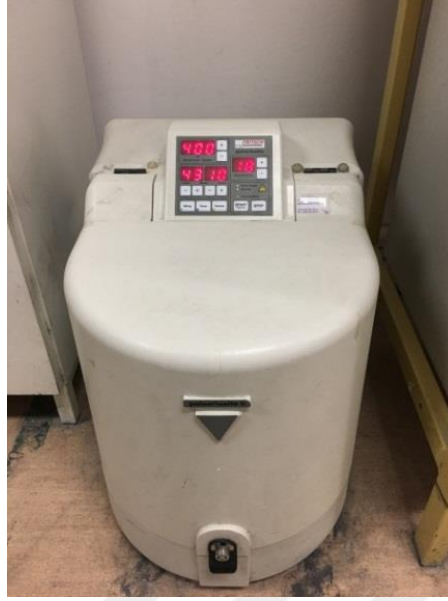
Görsel 3.2. Friszth Pulverizette-6 öğütme cihazı.
