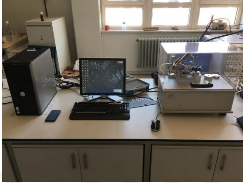
Görsel 3.4. CSM Instrument Tribometer aşınma testi cihazı.
