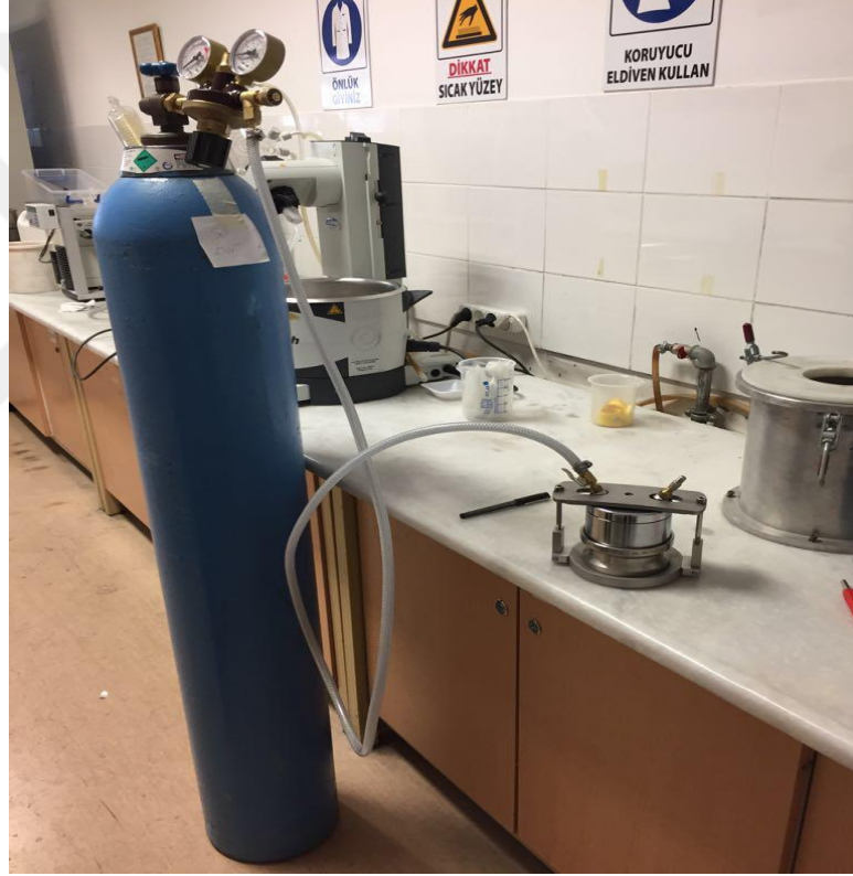
Görsel 3.1. Öğütme haznesinin Ar gazı ile doldurulması.
