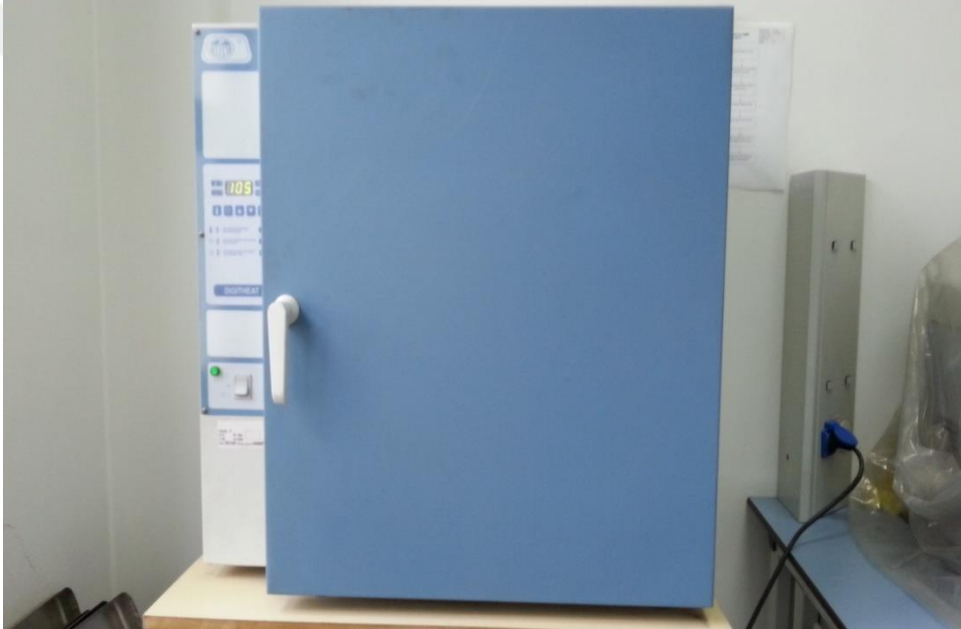
Şekil 6.6 Kuru madde tayininde kullanılan etüv
