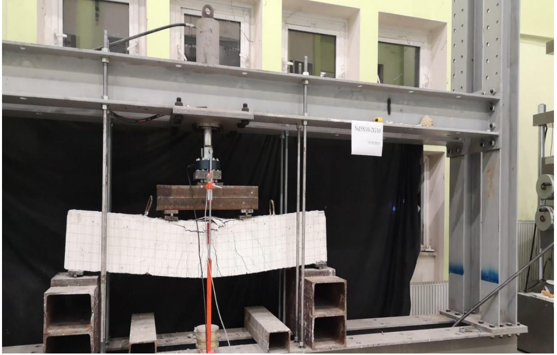
Şekil 2.30. (Nd5S10-2G10) Kirişi Yükleme Sonrası Durumu
