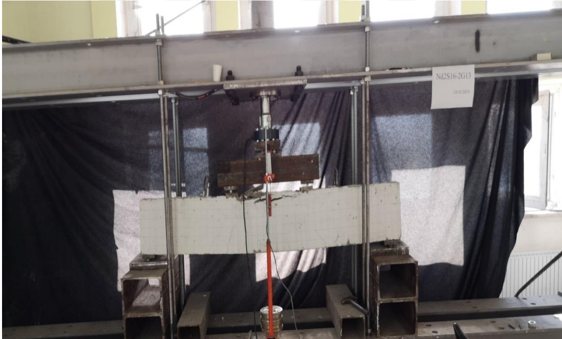
Şekil 2.22. (Nd2S16-2G13) Kirişi Yükleme Sonrası Durumu
