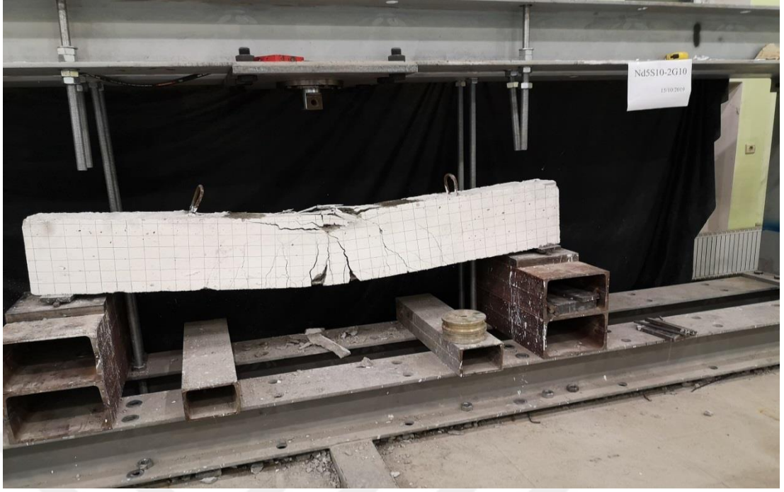
Şekil 2.31. (Nd5S10-2G10) Çatlak Gelişimi
