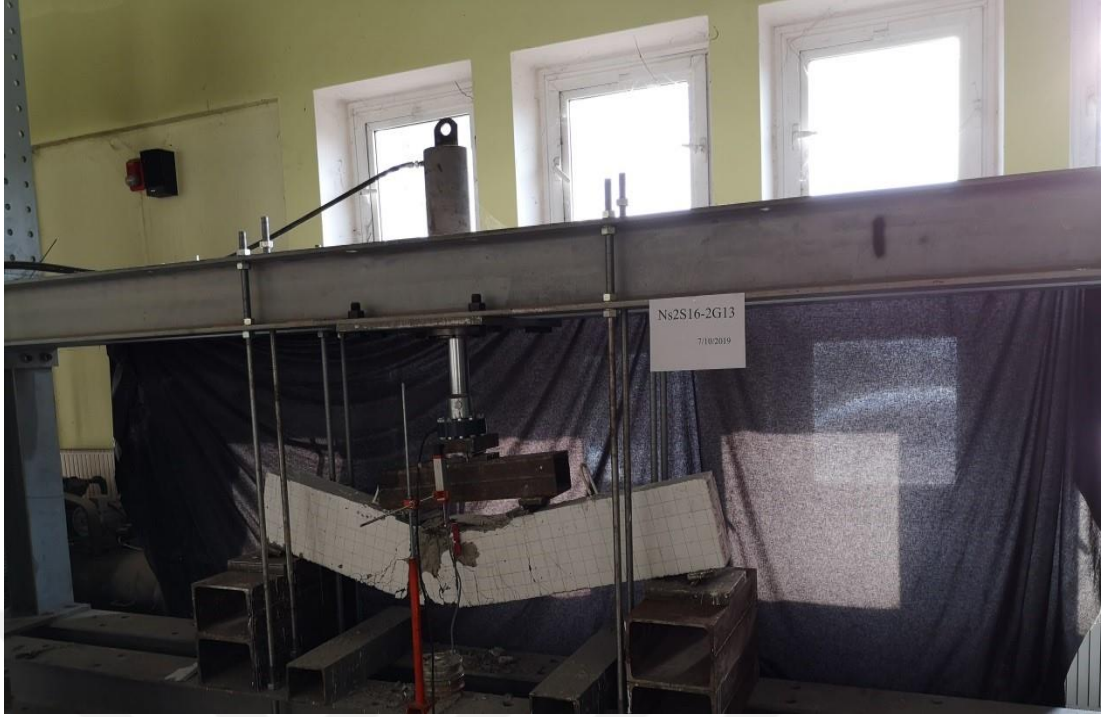
Şekil 2.14. (Ns2S16-2G13) Kirişi Yükleme Sonrası Durumu
