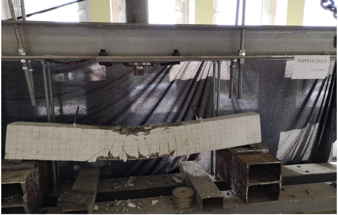
Şekil 2.27. (Nd5S10-2G13) Çatlak Gelişimi
