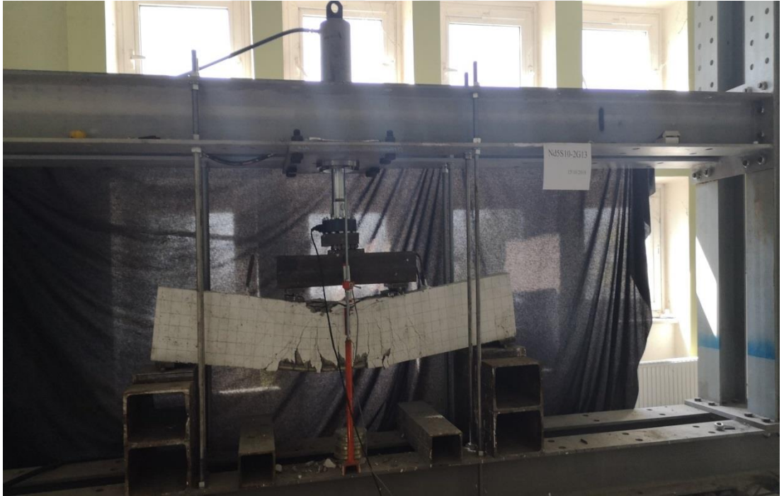
Şekil 2.26. (Nd5S10-2G13) Kirişi Yükleme Sonrası Durumu
