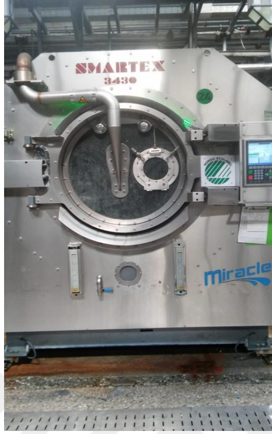
Şekil 5.2: Endüstriyel tipte denim yıkama makinası
