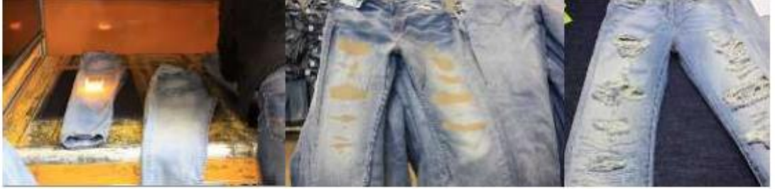
Şekil 4.1: Denim ürünlerde lazer işlemi ve lazerle elde edilen yıpratma görünümü
