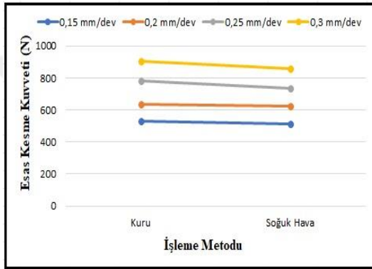
c) 160 m/dak kesme hızı ile işlemede oluşan kesme kuvvetleri
