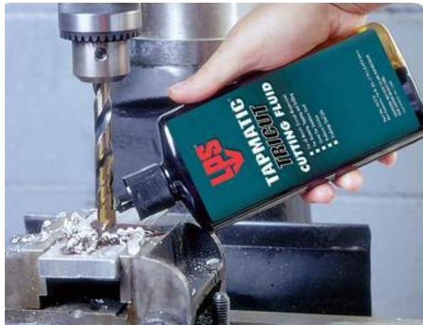
Şekil 4.10. Kesme sıvısının elle uygulanması [44].
