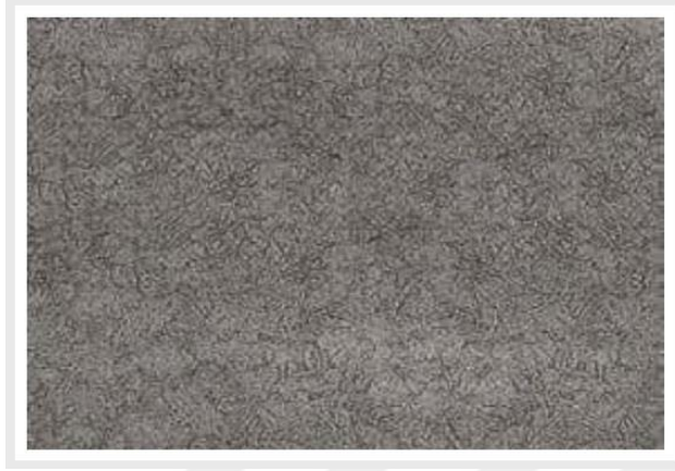
Şekil 3.4. Martenzitik paslanmaz çelik mikro yapısı [30].
