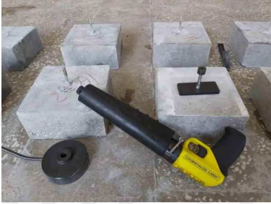
Şekil 25. Windsor prob testi uygulanmış numuneler ve test cihazı.
