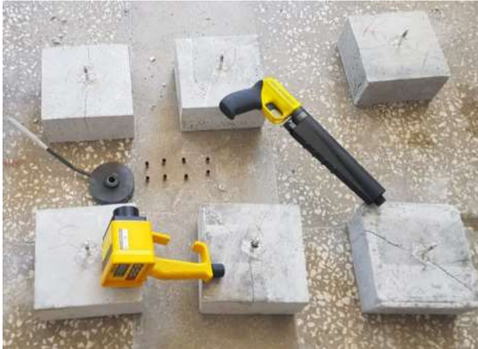
Şekil 26. Windsor prob test cihazı, ölçüm cihazı ve numuneler.
