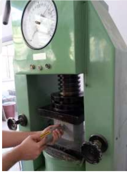
Şekil 21. Beton test çekici testleri
