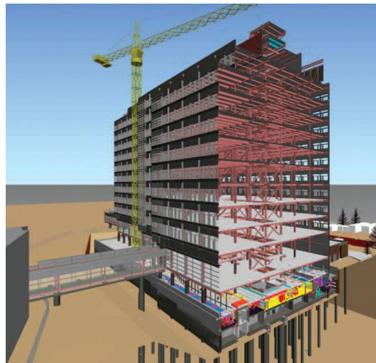
Şekil 3.9. BIM modelinde kule vinç görünümü (www.researchgate.net)
