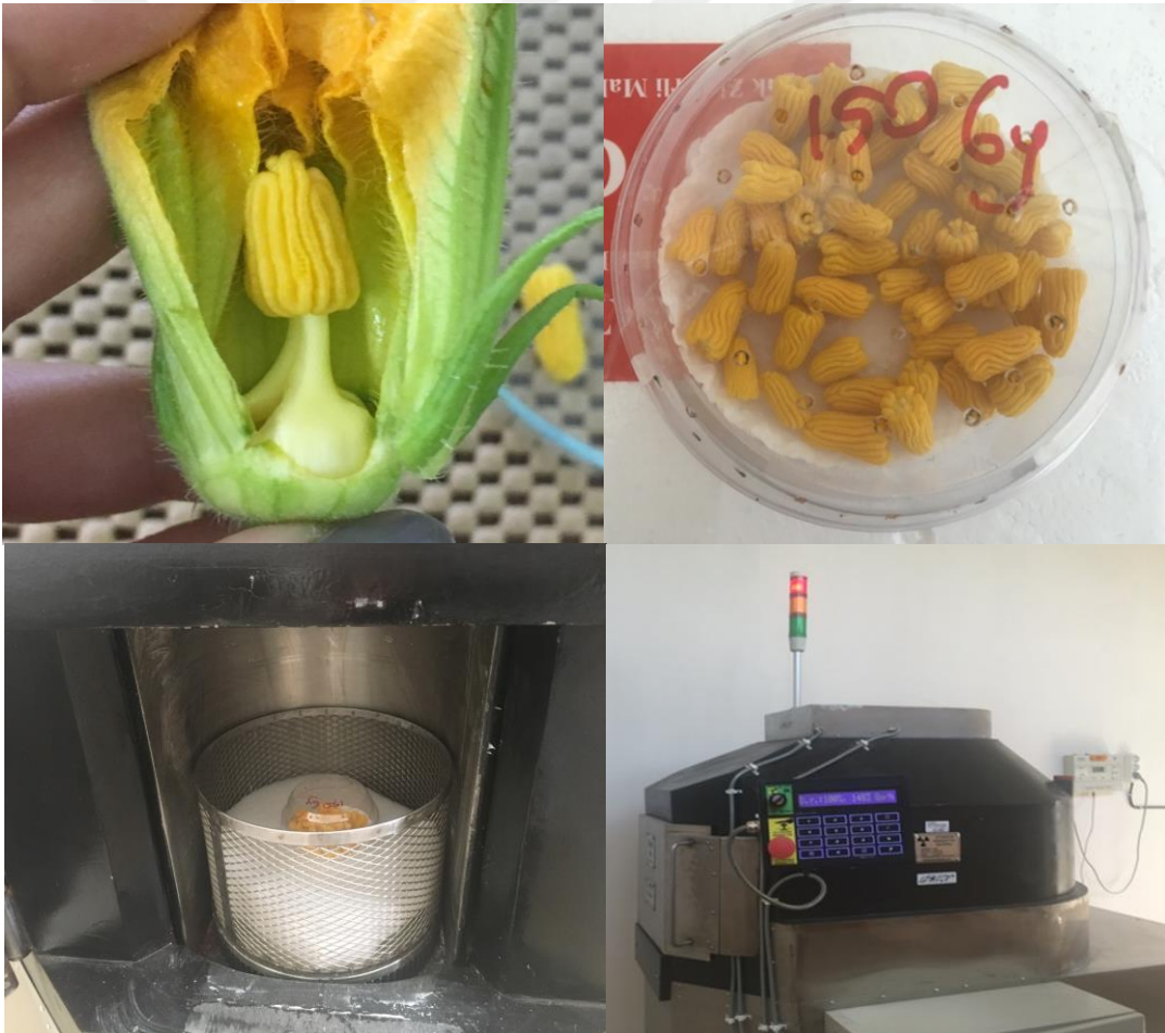
Şekil 3.2.2. Işınlama için hazırlanmış anterler ve anterlerin TAEK'te ışınlanması
