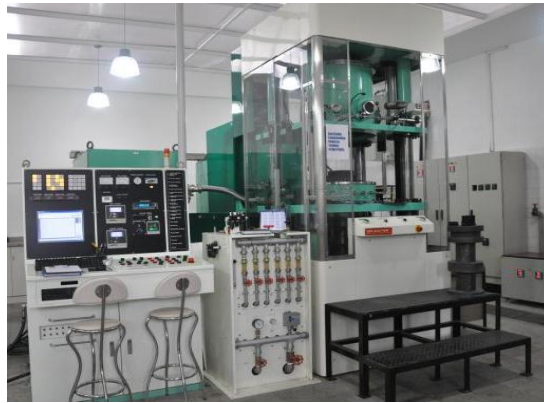
Şekil 5.4 : Numunelerin üretildiği SPS sistemi.
