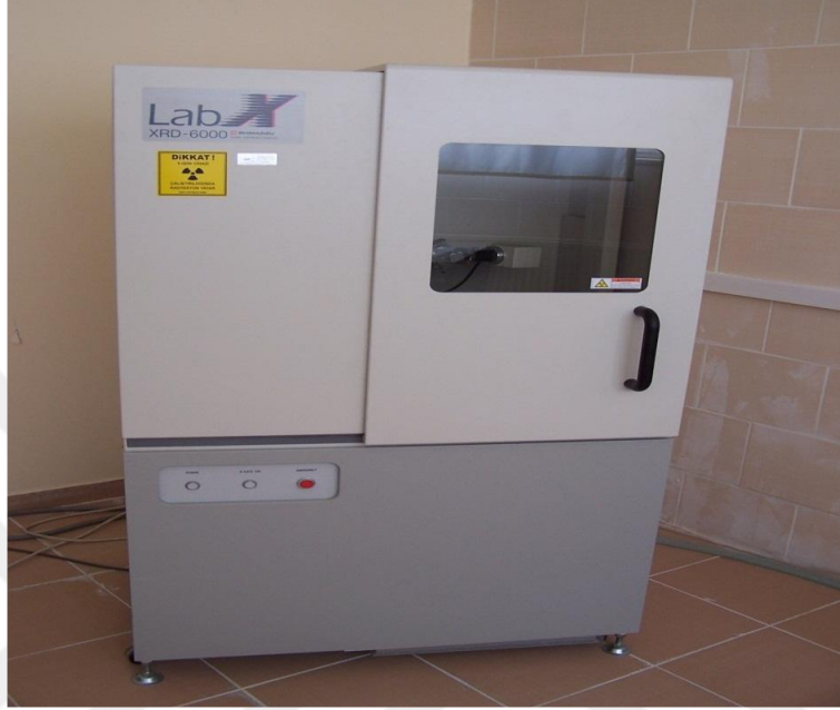
Şekil 4.2. Shimadzu XRD-6000 markalı XRD Cihazı
