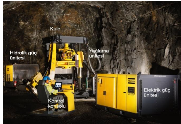
Şekil 2.8 : Makinenin temsili saha kurulumu, Atlas Copco Rock Drills AB (2012)'den uyarlanmıştır.
