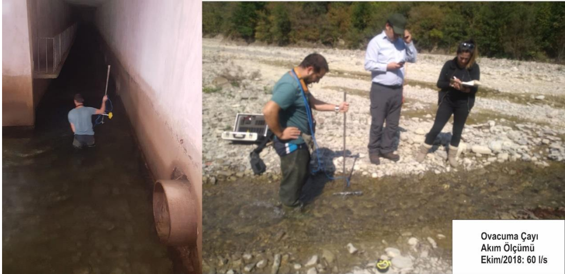
Şekil 2.1. Bahçecik Kaynağı kaptajında ve Ovacuma Çayı'nda muline cihazı ile debi ölçümlerinin alınması
