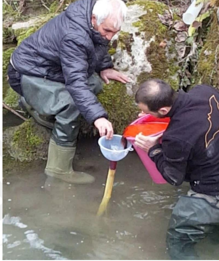
Şekil 2.8. Kayabaşı Deresi Subatan-2’de doğal akışla boya enjeksiyonu
