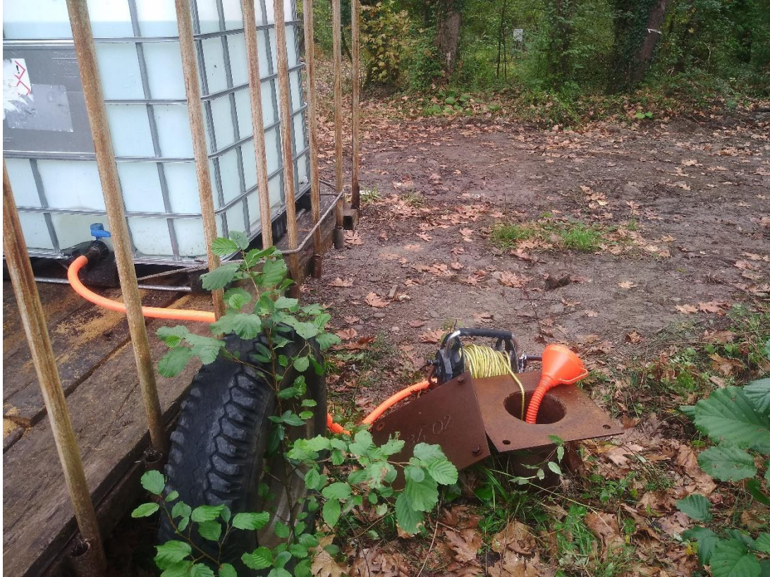
Şekil 2.11. Boya deneyi sonrası kuyuya verilen su ve seviye ölçümü
