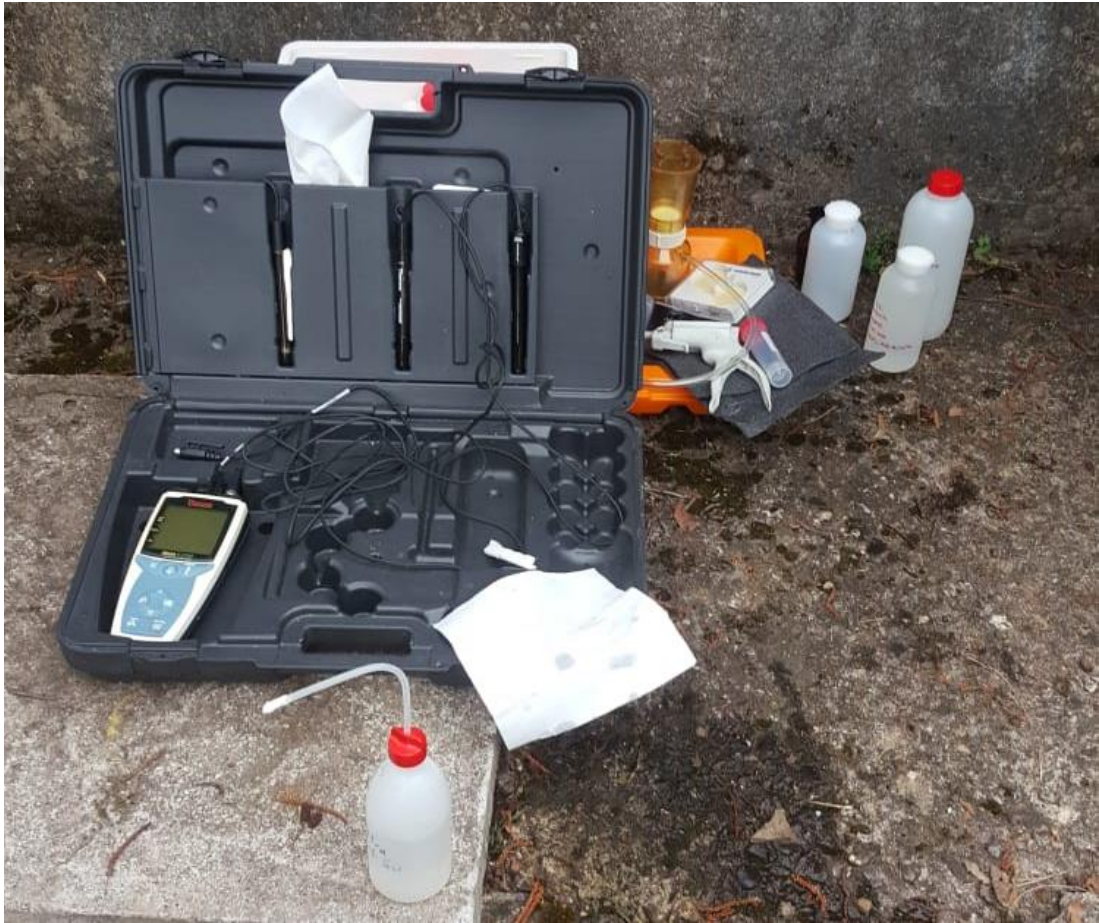
Şekil 2.14. Bahçecik Kaynağı'nda multiparametre cihazı ile yapılan yerinde ölçümden bir görünüm
