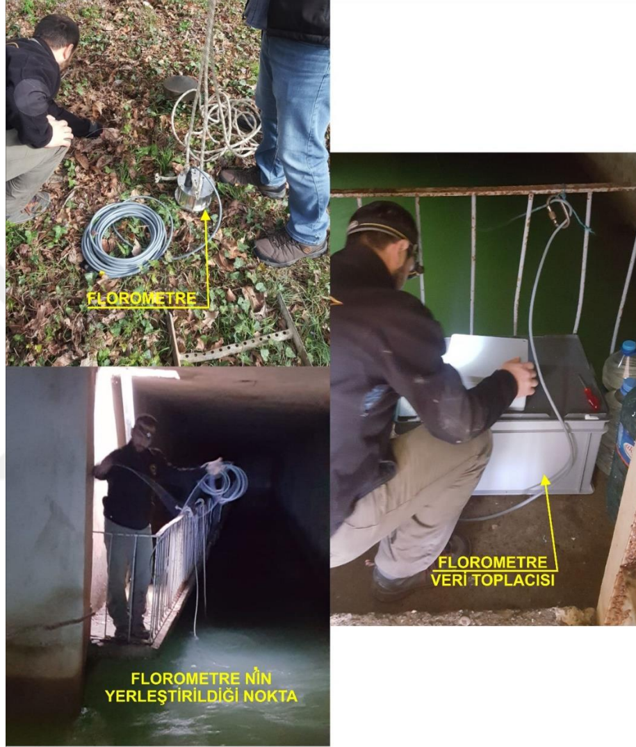
Şekil 2.12. Florometre cihazının Bahçecik kaynağı kaptajı içerisine yerleştirilmesi
