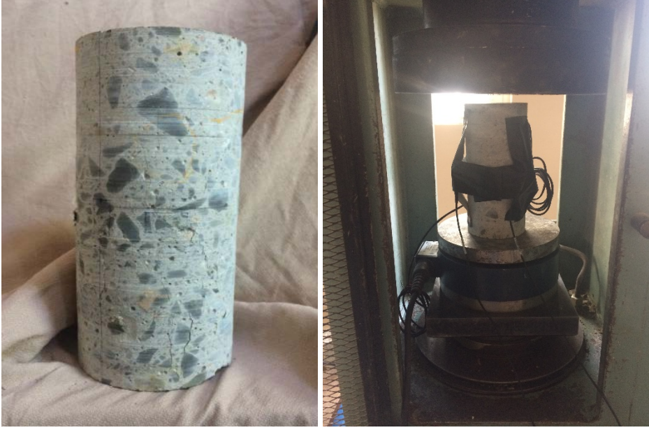
Şekil 5.7 C20 betonu karot 1
