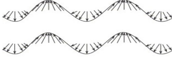
Şekil 2.9 Anti simetrik Lamb Dalgası (Su et al., 2006)
