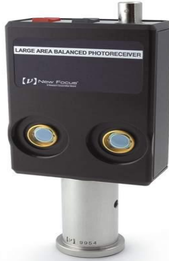
Şekil 3.8 Dengeli detektör (NEWPORT model 2307)
