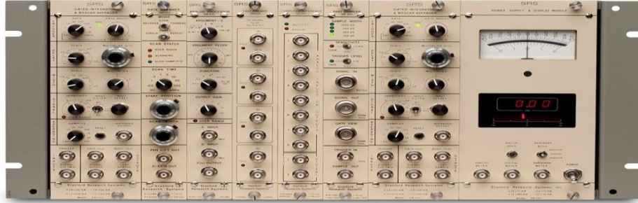
Şekil 3.10 Analog sinyalleri temizleyerek dijitalle çeviren ara yüz (Boxcar)
