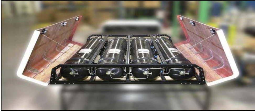
Şekil 4.9 CNG Yakıtlı Otobüslerin CNG Tankları
