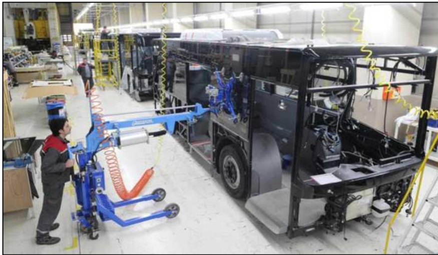
Şekil 4.4 Üretim Bandında Otobüs İmalat Ve Montajı
