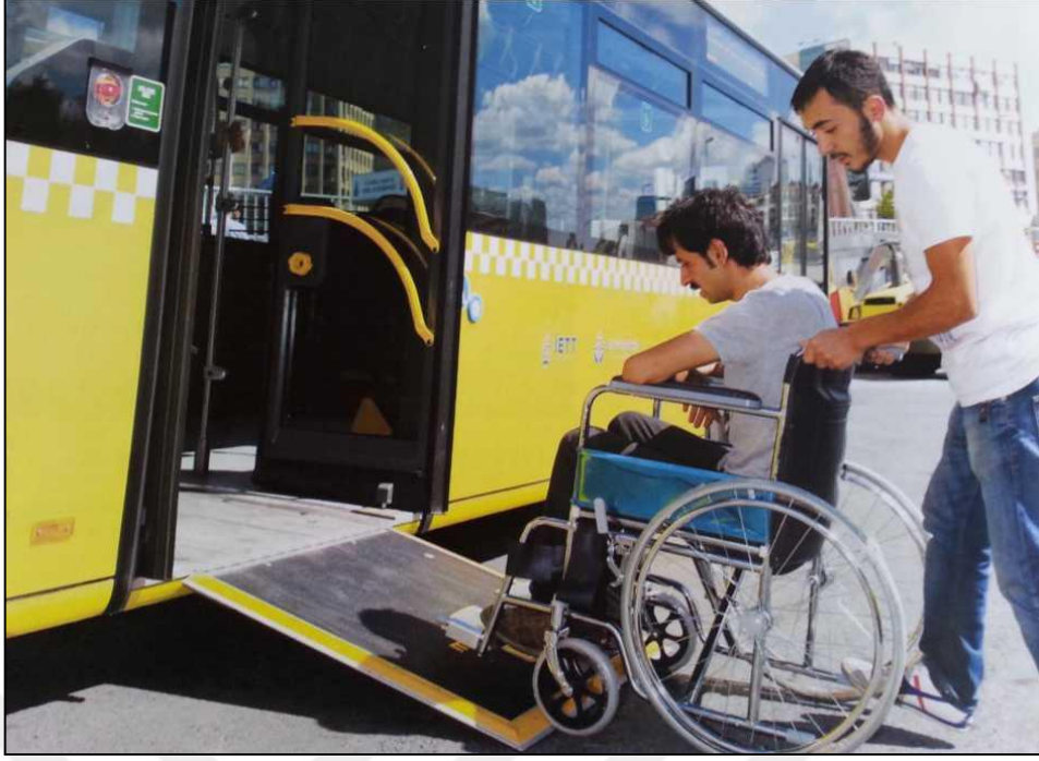
Şekil 4.8 %100 Engelli Erişimine Uygun Alçak Tabanlı Otobüsler
