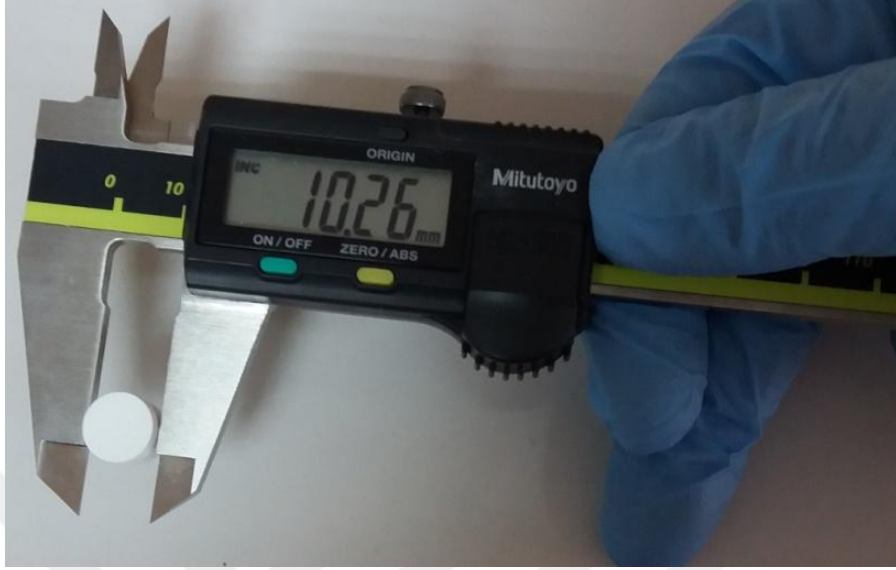
Şekil 3.7. Sinterlenen peletlerin mikrometre ile ölçümü.
