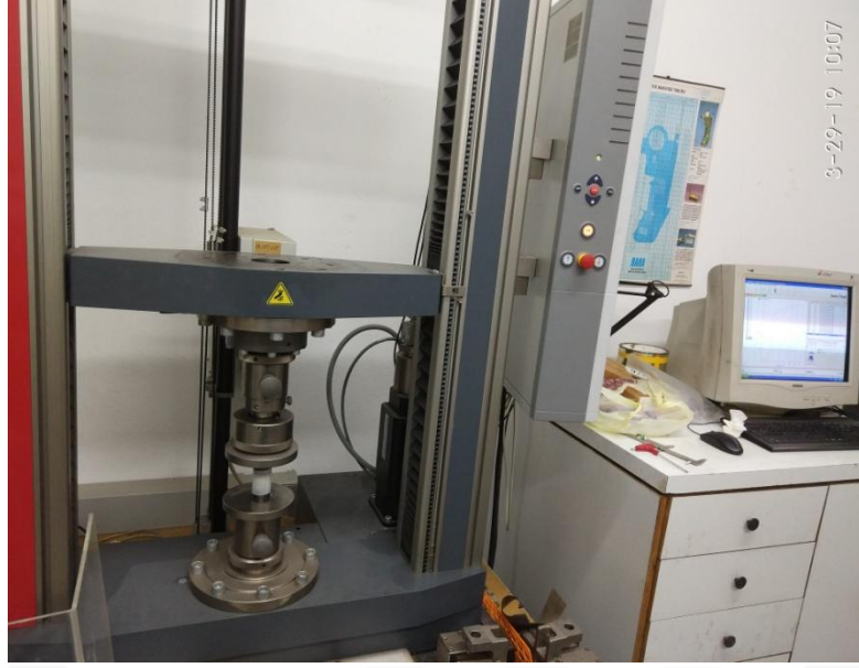
Şekil 3.8. Sinterlenen peletlerin basma testleri.
