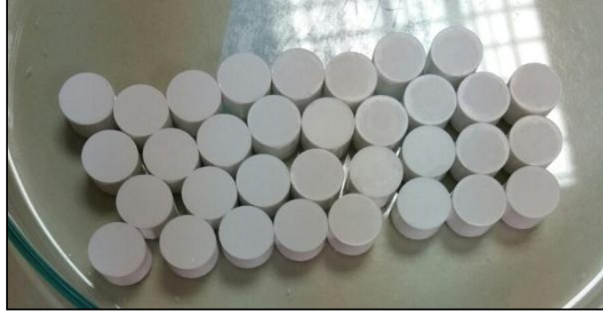
Şekil 3.4. Kalıptan çıkarılan peletler.
