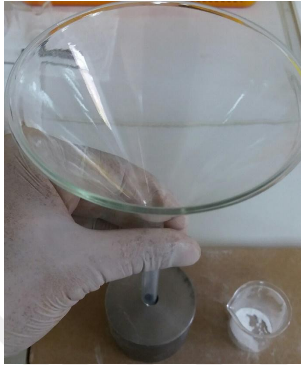
Şekil 3.2. HA ve ZnO'nun metal kalıp içerisine konulması.
