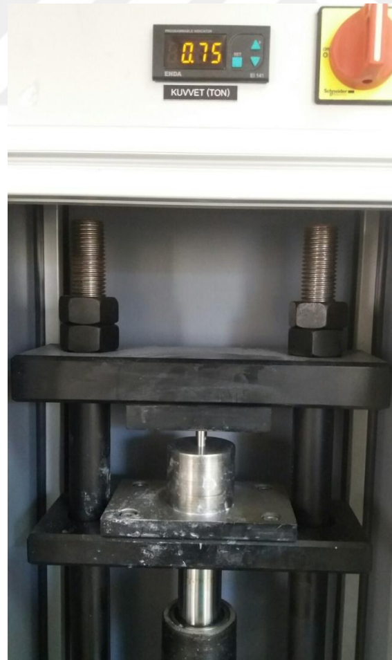
Şekil 3.3. Sentezlenen tozların tek eksenli preste sıkıştırılarak şekil verilmesi.
