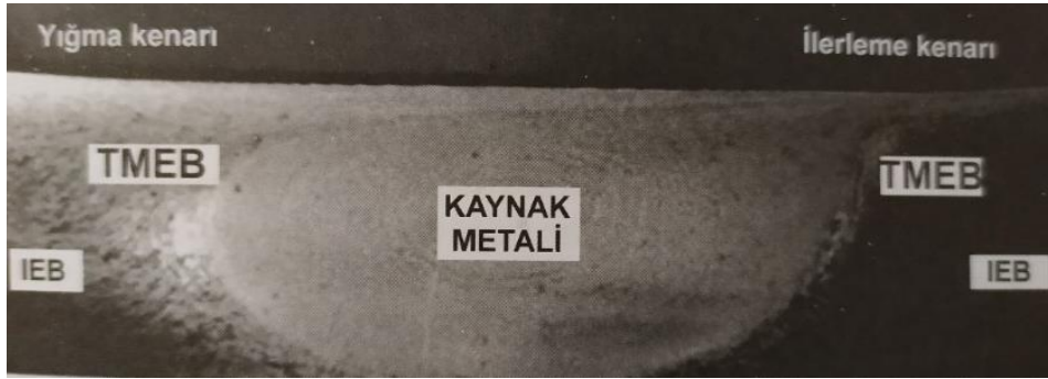
Şekil 3.12 Sürtünme karıştıma kaynağında kaynak bölgelerinin iç yapısının tipik görüntüsü [36].
