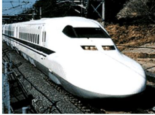
Şekil 2.1: Alüminyum profillerin sürtünme karıştırma kaynağı ile birleştirilmiş Shinkansen treni [1].
