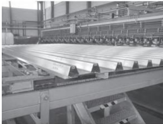
řekil 2.4: Helikopter inme alanı ve aęıkta zemin levhalarının sũrtũnme karıřtırma kaynađı [21]
