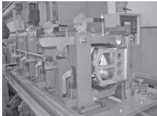
Şekil 2.2: Ford GT ara kanal sürtünme karıştırma kaynağı [21].
