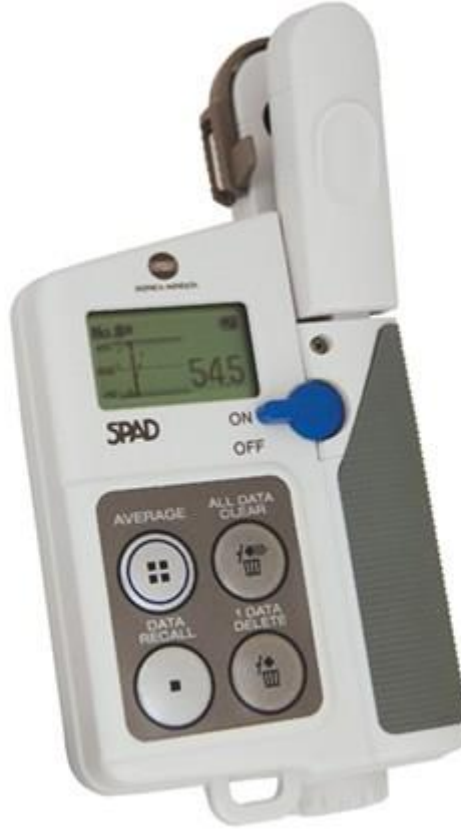
Şekil 3.9. Minolta SPAD 502 Plus Klorofilmetre (Anonim2019k)
