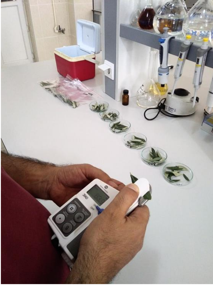
Şekil 3.17. Spad klorofilmetre ile klorofil ölçümü
