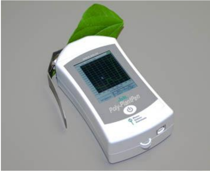
Şekil 3.10. Polypen RP-400 yaprak spektrometresi
