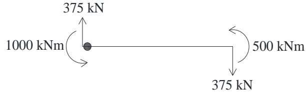
Şekil 3.14 : Kirişin orta noktasındaki plastik mafsallın birim dönmesinden oluşan ankastrelük uç kuvvetleri.
