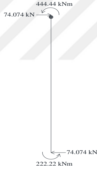
Şekil 3.24 : Birinci plastik mafsalsın birim dönmesinden oluşan ankastrelik uç kuvvetleri.
