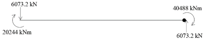
Şekil 3.96 : Birinci plastik mafsallık birim dönmelerinden oluşan ankastrelik uç kuvvetleri.
