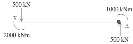
Şekil 3.30 : İkinci plastik mafsallık birim dönmesinden oluşan ankastrelik uç kuvvetleri.
