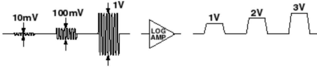
Şekil 2.2 Giriş işaretinin logaritmik yükseltece uygulanması ve elde edilen çıkış işareti [21]
