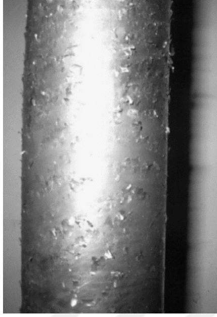
Şekil 1.1 Flowform sonrası yüzeyde pullanmalar [1]
