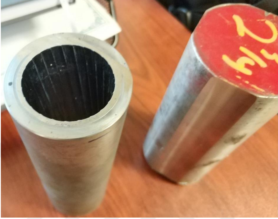
Şekil 4.3 Flowform namlusundan çekme numunesi üretim aşamaları 1
