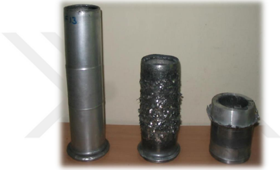
Şekil 2.8 Hatalı işlem sonucu ortaya çıkan flowform parçaları
