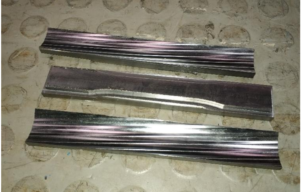
Şekil 4.4 Flowform namlusundan çekme numunesi üretim aşamaları 2
