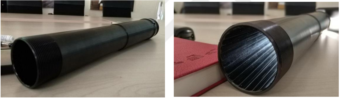
Şekil 3.7 Flowform ile üretilmiş 40mm bomba atar namlusu
