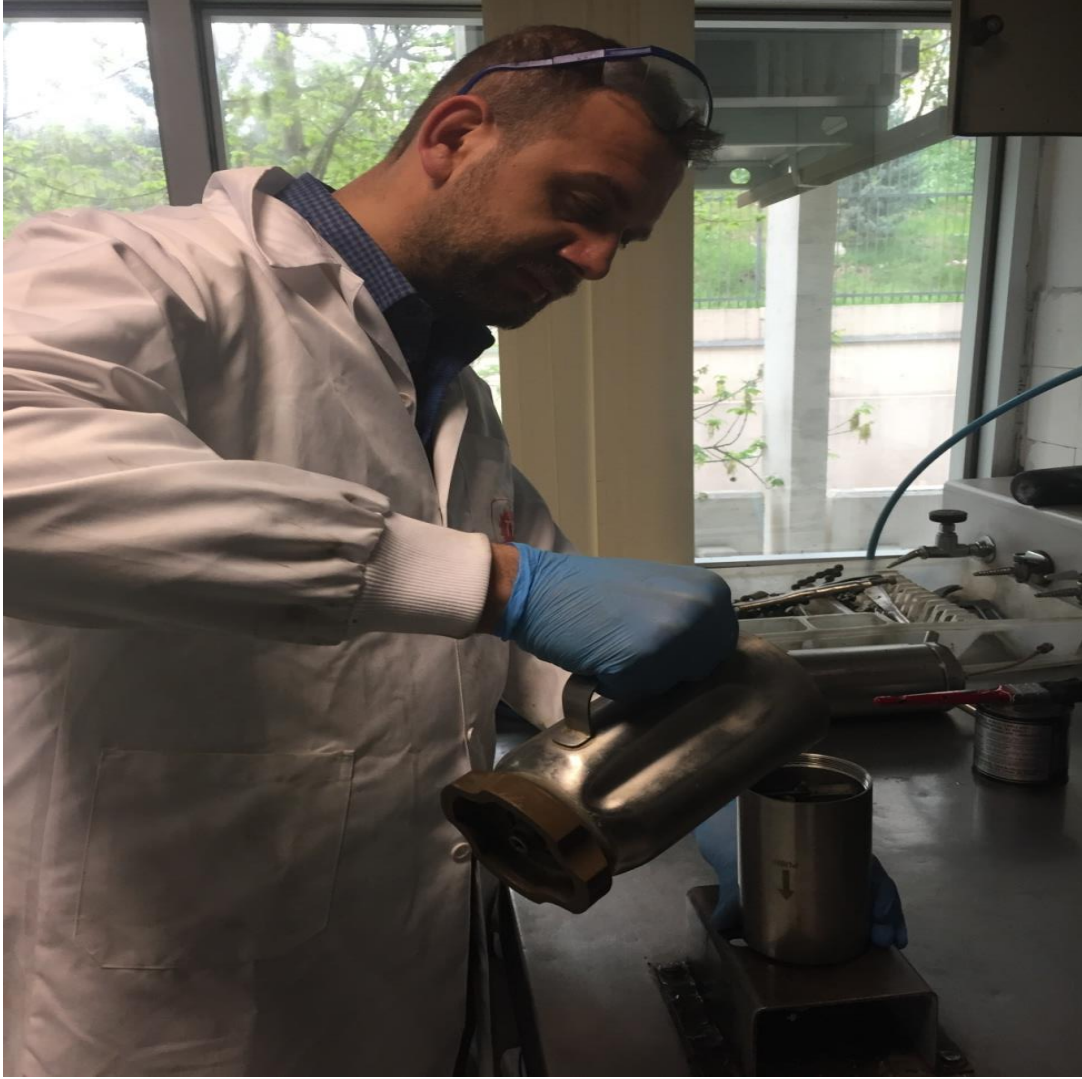
Şekil 3.8. Hazırlanan çimento şerbetinin prizlenme testi öncesi test kaplarına yerleştirilmesi
