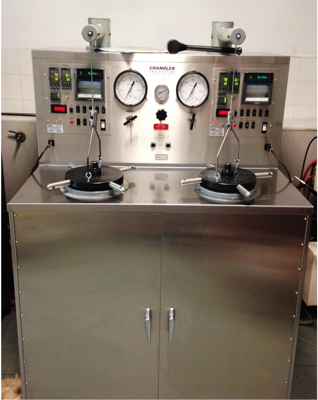
Şekil 3.9. Chandler Engineering 7025C10 model prizlenme süresi ölçüm cihazı
