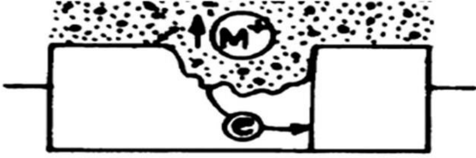
Şekil 2.3. Galvanik korozyon (Al-Eidan 2015)
