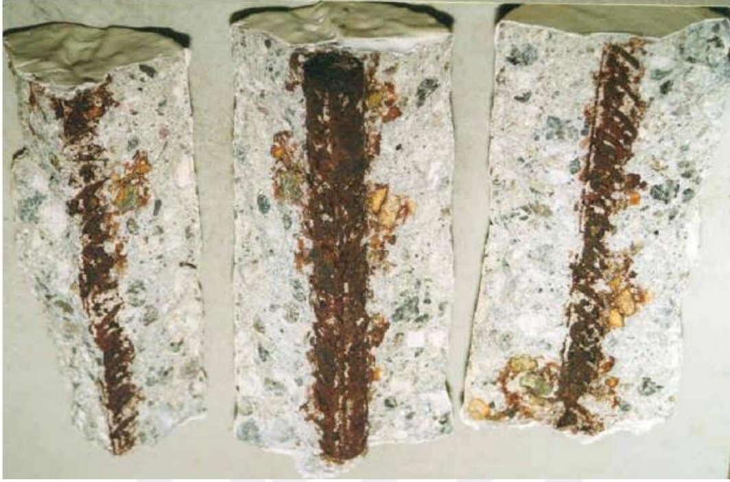
Şekil 2.13. %3,2 NaCl içeren çimento içindeki çeliğin 3 yıl süresince 38 °C - %90 bağıl neme maruz kalması sonucu oluşan korozyon (Justness 2003)
