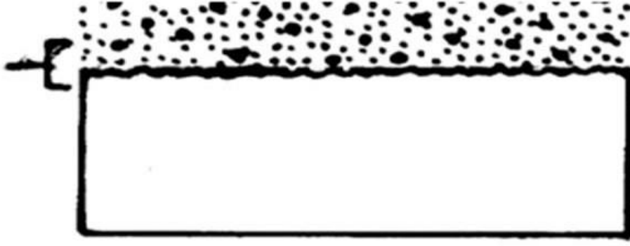
Şekil 2.4. Tanecikler arası korozyon (Al-Eidan 2015)
