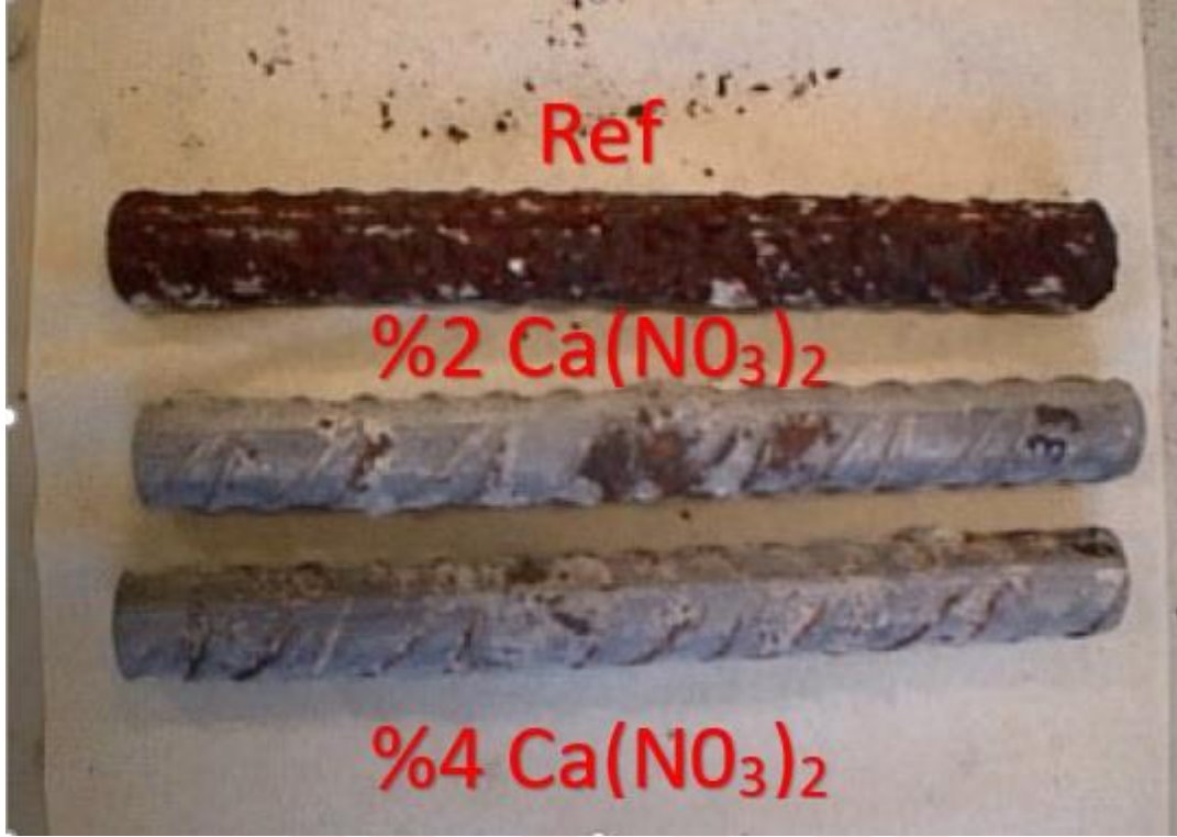
Şekil 2.16. %3,2 NaCl, %2 & 4 Ca(NO 3 ) 2 içeren çimento içindeki çeliğin 3 yıl süresince 38 °C - %90 bağıl neme maruz kalması sonucu çeliğin durumu (Justness 2003)
