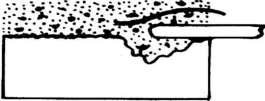
Şekil 2.5. Çatlak korozyonu (Al-Eidan 2015)
