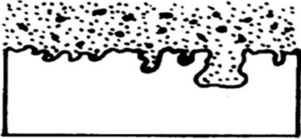
Şekil 2.2. Çukur korozyon (Al-Eidan 2015)
