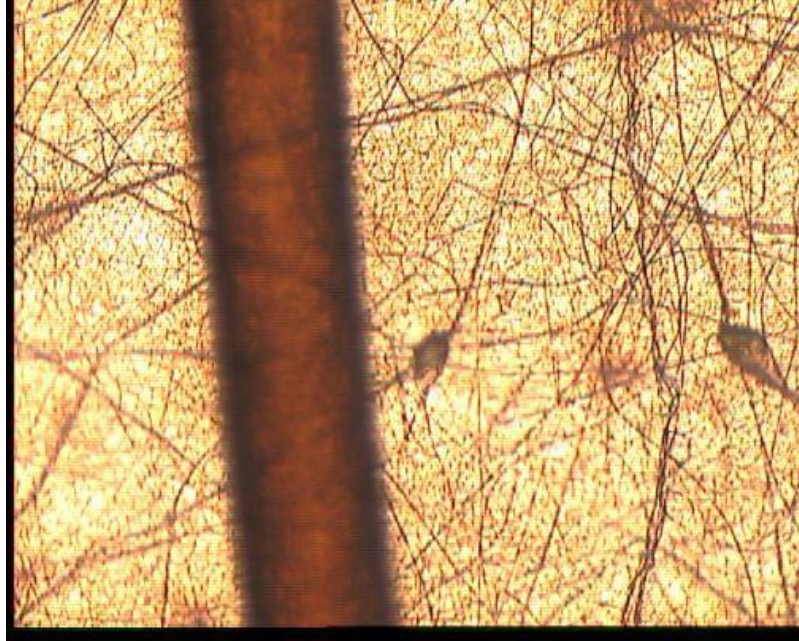
Şekil 1.1. Fiberlerin saç teliyle karşılaştırılmış mikroskop görüntüsü (Altaş ,2009).
