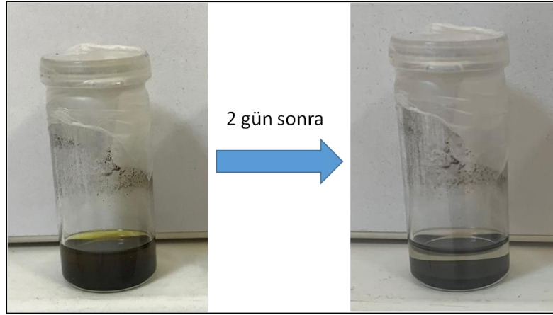
Şekil 8.4: Adsorbsiyon testine ait fotoğraflar. \text{Li}_2\text{S}_4 , 2 gün bekleme süresi sonunda kırmızımsı rengin kaybolmasından anlaşılabileceği gibi, \text{TiO}_2/\text{G} tarafından yakalanmıştır.
