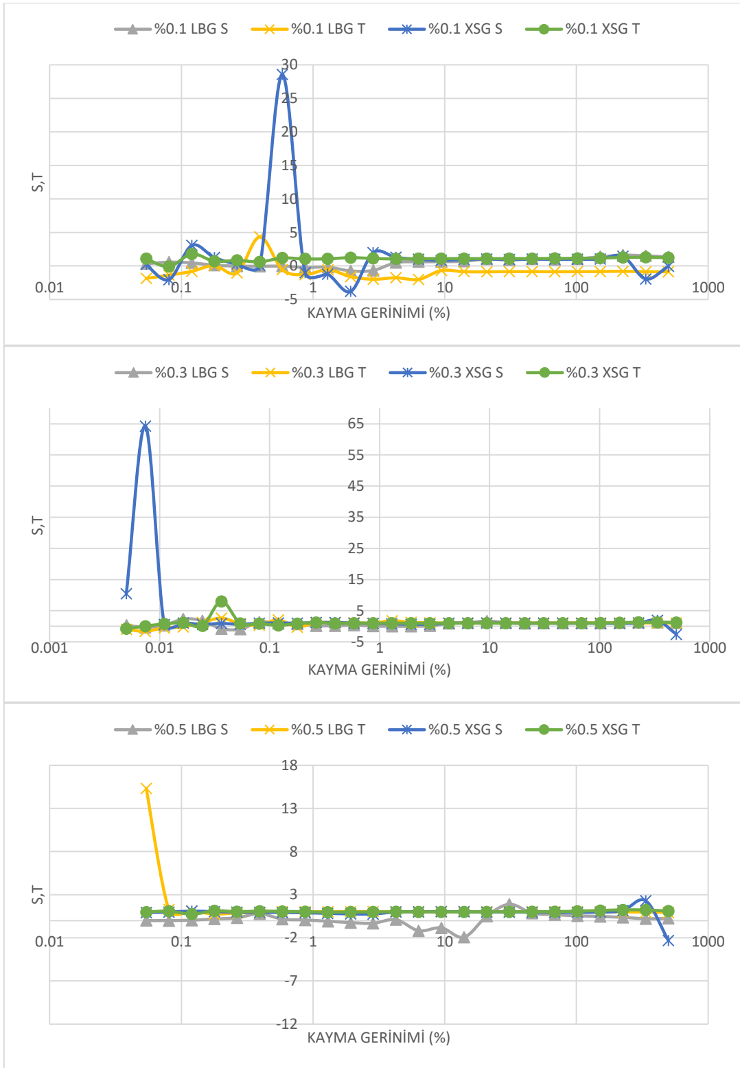
Şekil 4.13 %0.1,%0.3 ve %0.5 konsantrasyonda hazırlanmış LBG ve XSG çözeltileri için elde edilen S,T eğrileri
