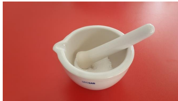
Şekil 3.6. Malzemelerin toz hale getirilmesinde kullanılan seramik havan.
