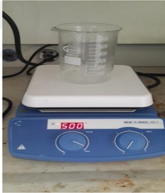
Şekil 4.1. 500 °C de Hot plate üzerindeki dozimetrik malzeme.
