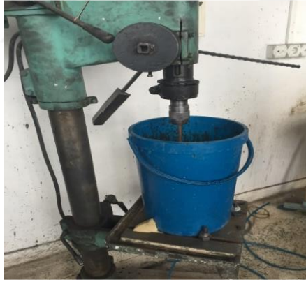
Şekil 3.7. Olgunlaşmış katı solucan gübresinin sıcak KOH çözeltisi ile karıştırılması.
