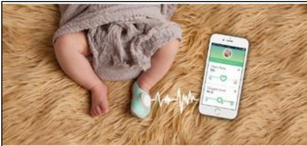
Resim 1.5. Bebekler için giyilebilir bir cihaz (owlet) (“OwletCare—Baby Monitor | Track Heart Rate and Oxygen”, 2019)
