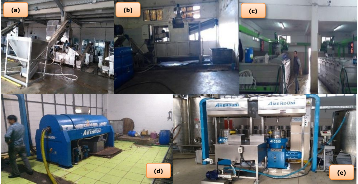
Şekil 3.9. Ses Düzeyi Ölçümleri Üniteleri, a) Yükleme ünitesi, b) Temizleme ünitesi, c) Kırma ve yoğurma ünitesi, d) Santrifüjleme Ünitesi, e) Ayırma Ünitesi
