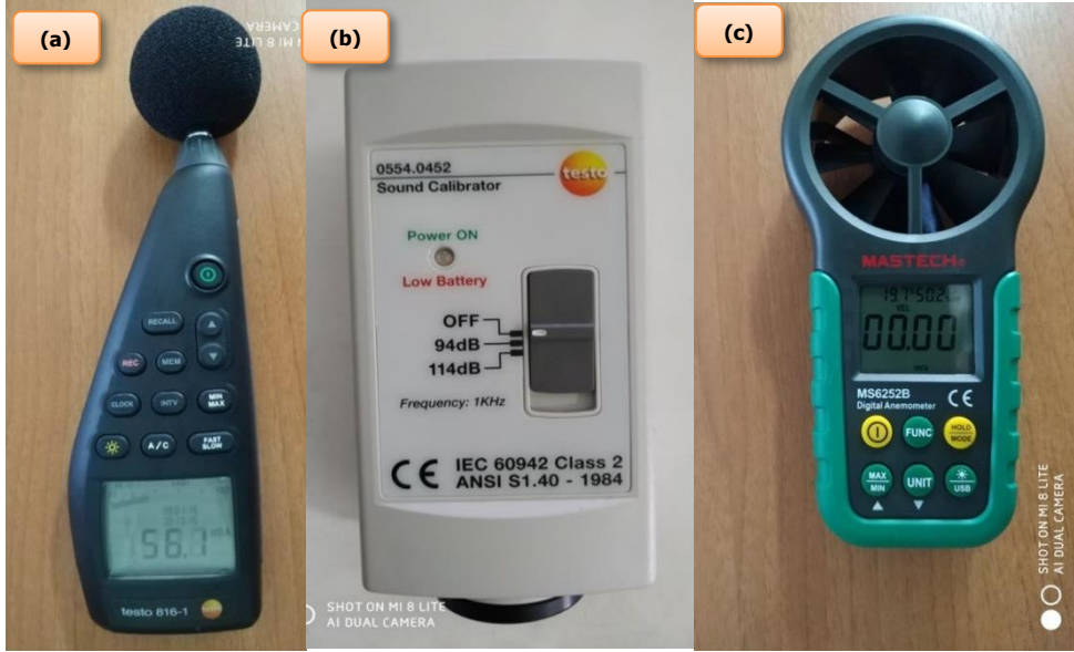
Şekil 3.8. Ölçüm cihazları, a) Ses basınç düzeyi ölçer, b) Kalibratör, c) Anomometre
