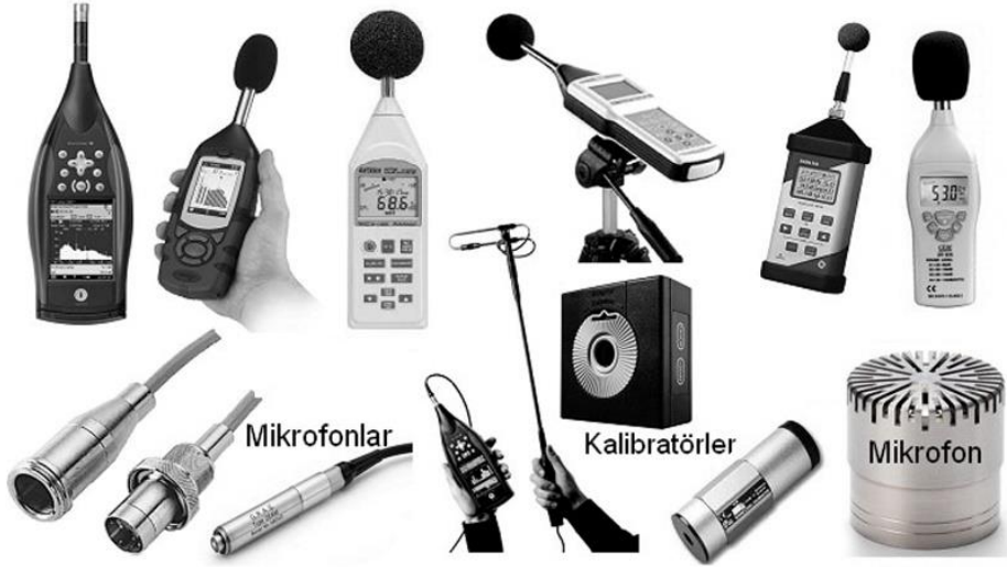
Şekil 1.12. Ses basıncı ölçerler ve aksesuarları (Sabancı ve Sümer, 2012)
