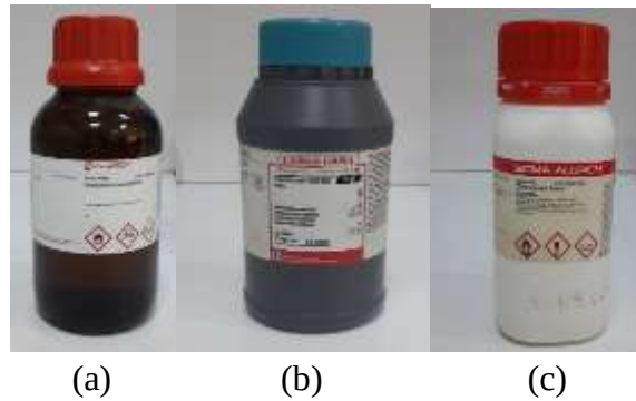
Şekil 2.14. Hibrit nanoparçacık üretmek için kullanılan kimyasallar sırasıyla (a) Titanyum İzopropoksit, (b) Alüminyum Nitrat, (c) Çinko Nitrat Hekzahidrat
