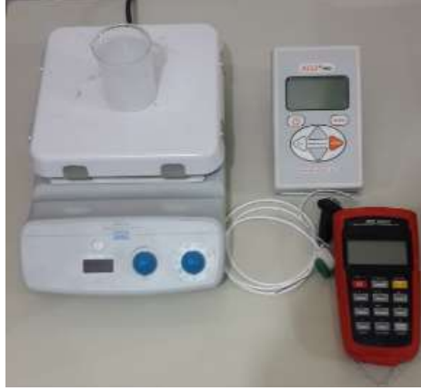
Şekil 2.18. Isıl iletkenlik ölçümü için kurulan deney düzeneği
