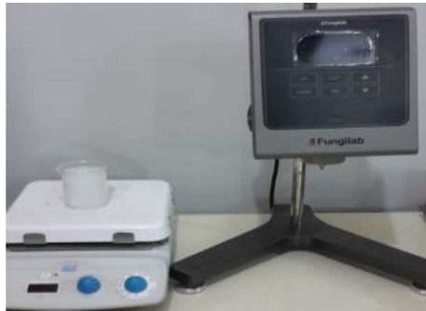
Şekil 2.19. Viskozite ölçümü için kurulan deney düzeni
