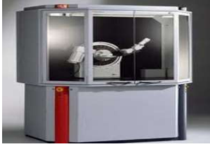
Şekil 2.9. X-Işını Kırınım cihazı [75].
