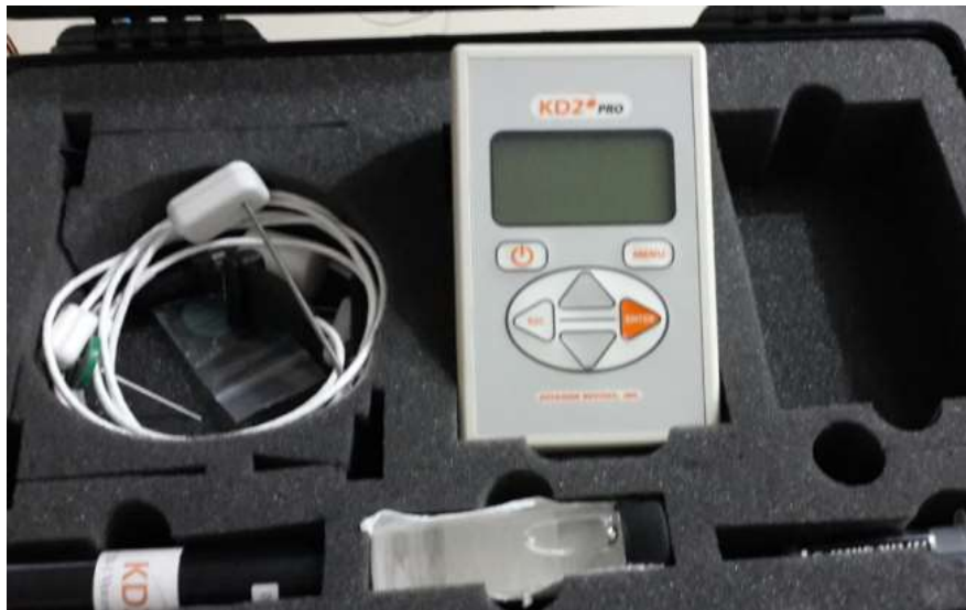
Şekil 2.12. KD2 Pro Isıl Özellik Ölçer
