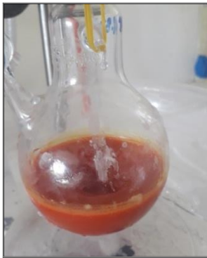
Şekil 3.11. Triizopropilbenzenülfonilhidrazonun n-butillityum ilavesinden sonraki renk değişimi
