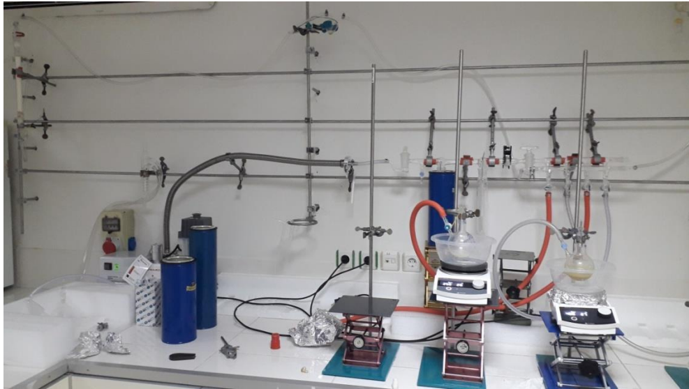
Şekil 3.1. Deneylerin gerçekleştirildiği Schlenk düzeneği
