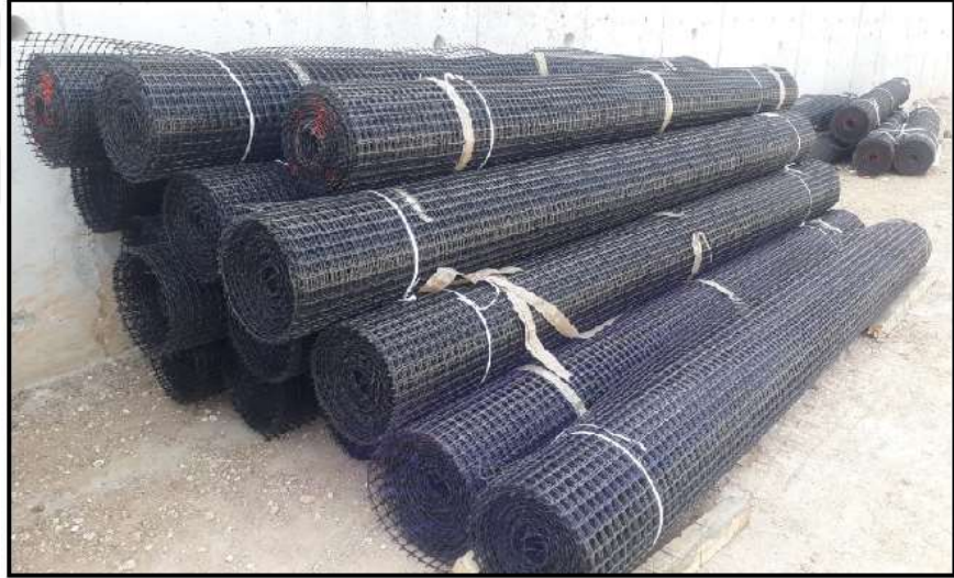
Şekil 4.17. Jeogridlerin istiflenmesinden bir görünüm
