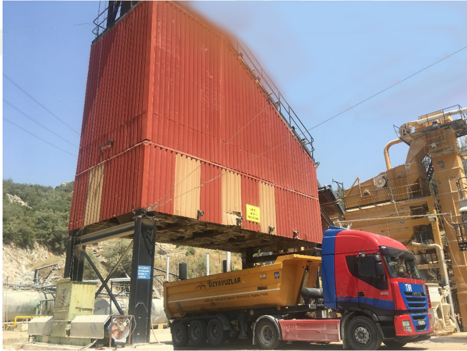
Şekil 3.2 Asfalt yükleme işlemi (Kişisel arşiv, 2018)
