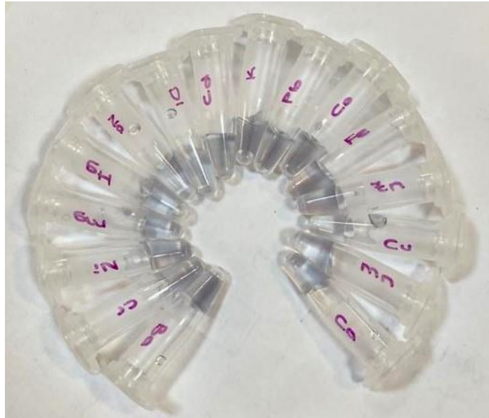
Şekil 3.15: 5-Amino-1,3,4-Tiyadiazol-2-Tiyol ile fonksiyonelleştirilmiş sitrat kaplı altın nanoparçacıkların metal tuzlarıyla kolorimetrik yanıtı.
