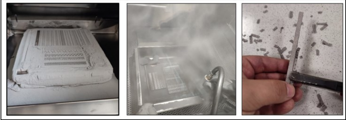
Şekil 4.7. Üretim sonrası temizlik süreci ve destek yapıların sökülmesi
