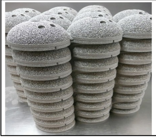
Şekil 2.5. EBM' de yığın halinde parça üretimi [6]
