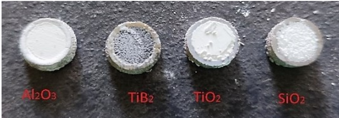
Şekil 4.2. Numunelere sıkıştırılmış tozların üstten görüntüsü
