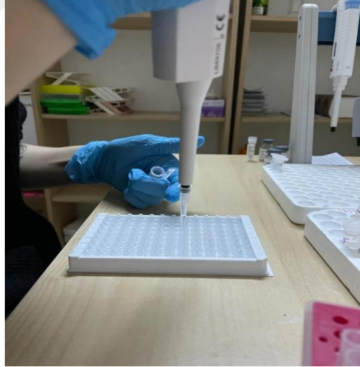
Şekil 8. Standart solüsyonun seyreltilmesi işlemi
