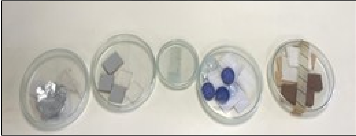
Resim 4.1. Test örnekleri (pürüzlü yüzeyli tahta, tırtıklı yüzeyli tahta, düz yüzeyli tahta, kağıt havlu, karton, cerrahi maske, kumaş, plastik su şişesi kapağı, plastik şişe parçası, madeni para, çengel iğne, plastik oyuncak parçası, cam, alüminyum folyo: 2\text{ cm}^2 )
