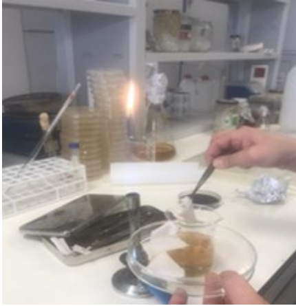
Resim 4.3. Biyolojik indikatör ile materyallerin bütün yüzeylerinin kontaminasyonu
