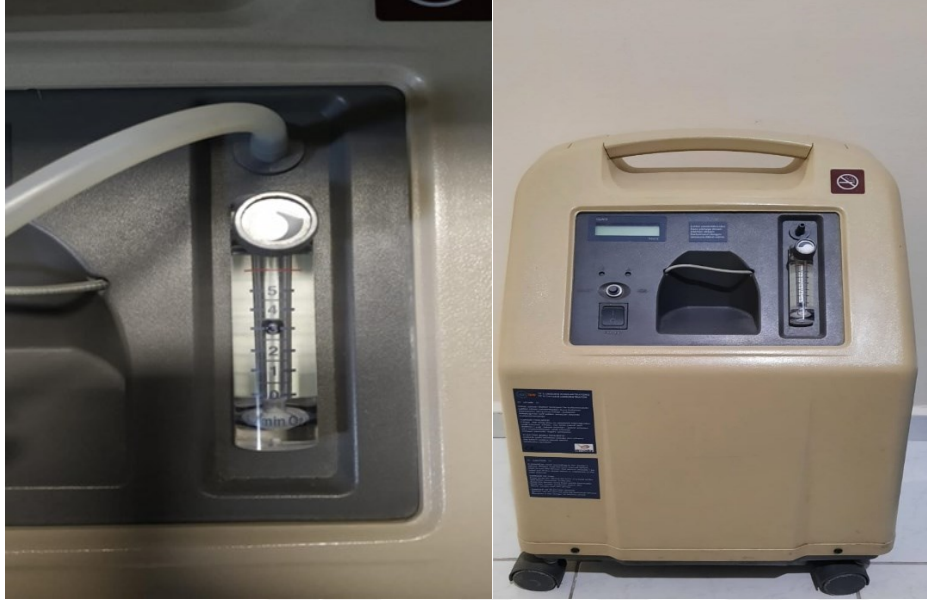
Resim 4.6. Oxytime 7F-5 oksijen konsantratörü
