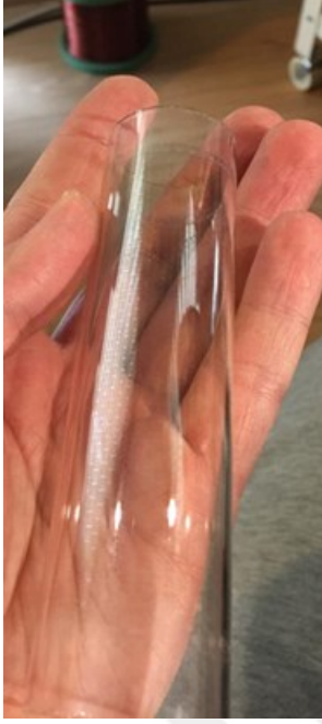
Resim 3.3. Plazma ile delinmiş cam
