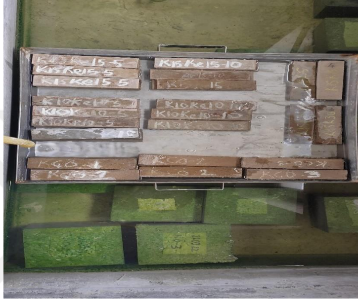
Resim 3.12 24 saat su içerisinde bekletilen numuneler.
