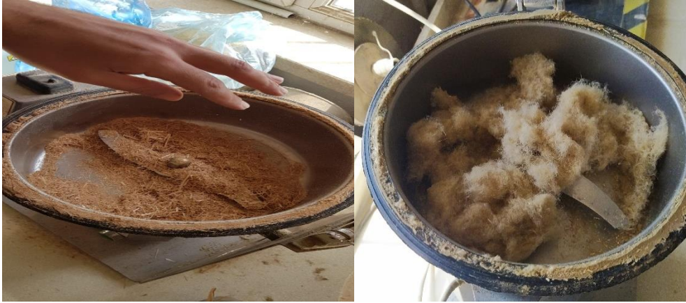
Resim 3.7 Öğütülen kamış lifleri (solda) ve öğütülmüş keten lifleri (sağda).
