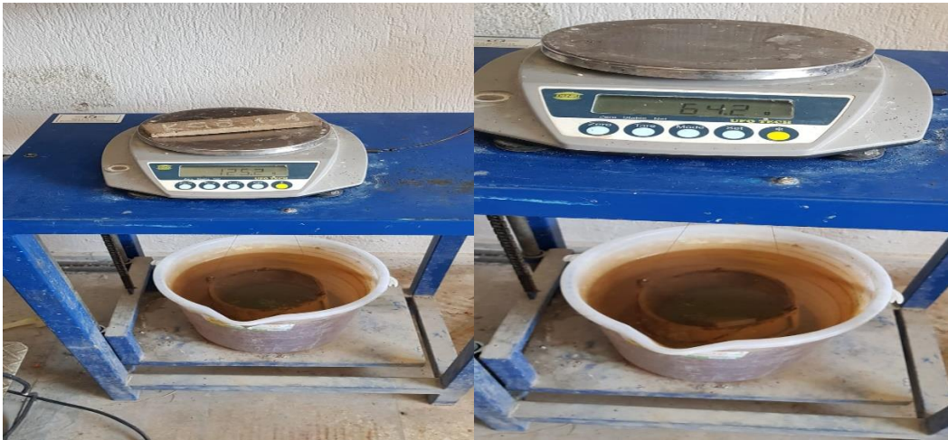
Resim 3.13 Numunelerin doymun kuru yüzey ağırlığı (solda) ve su içindeki ağırlığı (sağda) verilmiştir.
