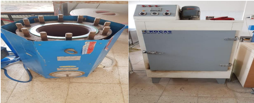
Resim 3.11 Çalışmada kullanılan otoklav (solda) ve etüv (sağda).
