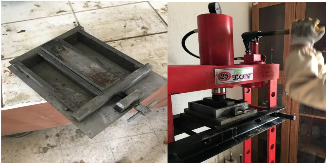
Resim 3.9 Çalışmada kullanılan çelik kalıp (solda) ve pres makinesi (sağda).
