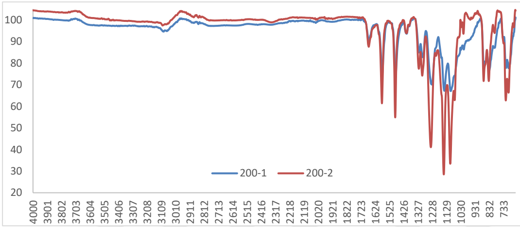
Şekil 4. 10 : SiO 2 katkılı polisülfon membrana ait FTIR grafiği.
