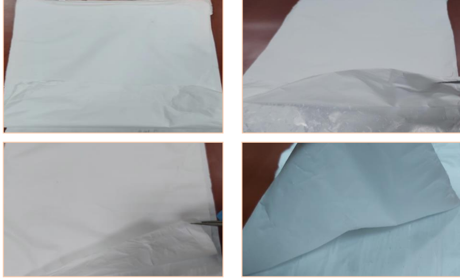
Şekil 3.4.2 Elektrospin yöntemiyle üretilmiş nanofiberler
