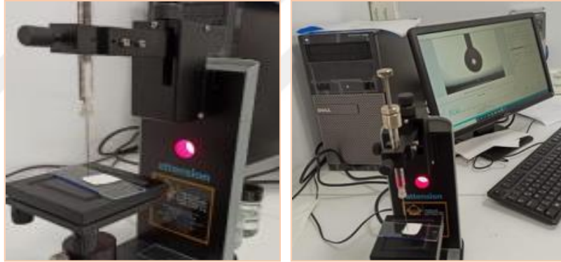
Şekil 3.5.1. Temas açısı ölçüm cihazı
