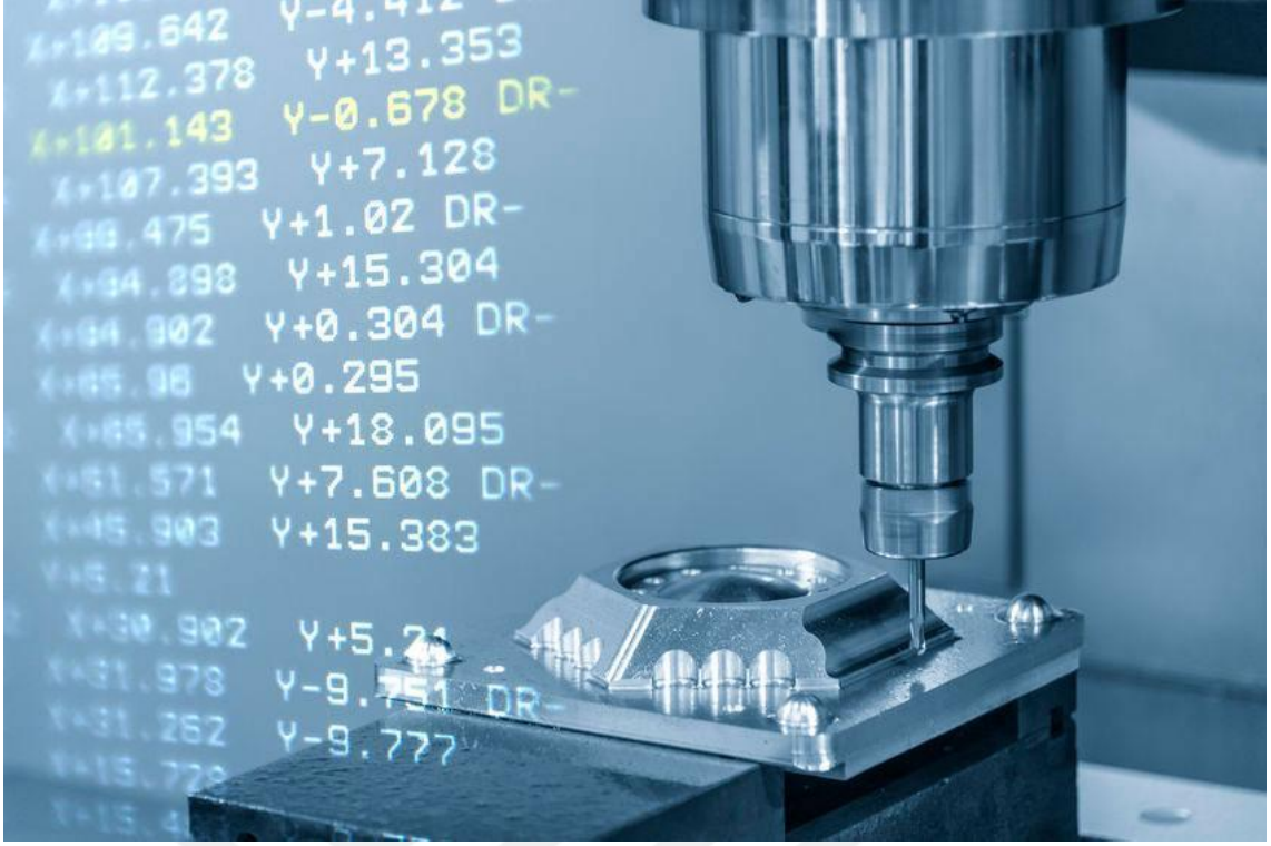
Şekil 2.4 Üç eksen CNC sisteminin şekli ve kodlama sistemi [34]
