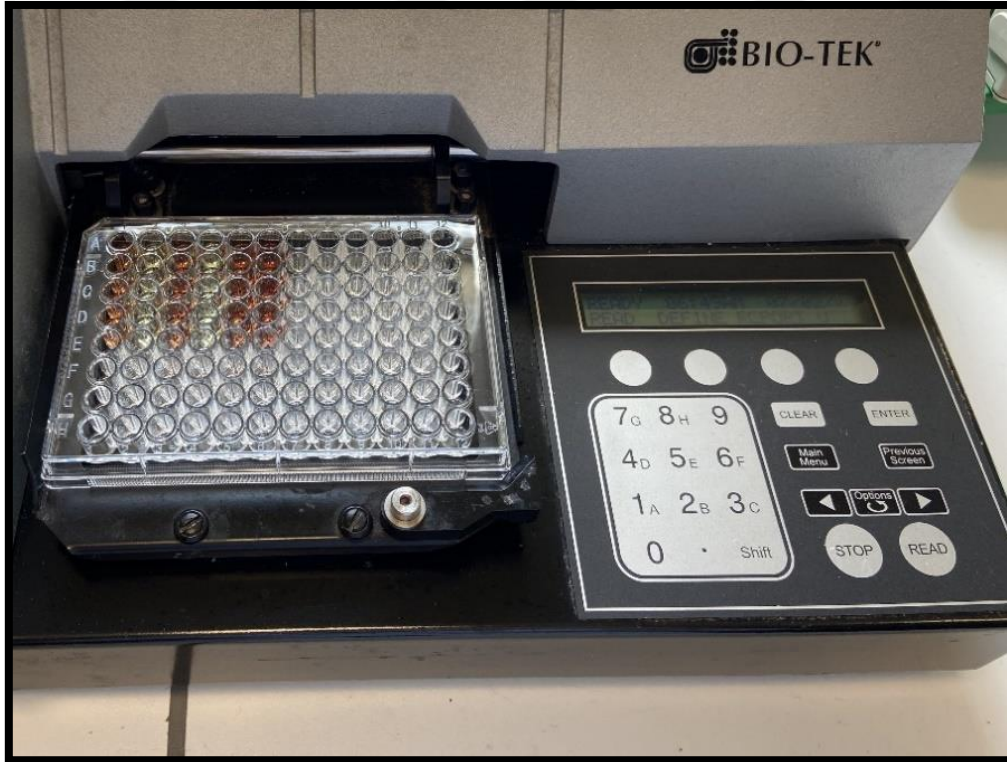
Şekil 3. 9: İnkübasyon sürecinden sonra 490 nm dalga boyunda abzorban ölçümü yapılan ELISA plaka okuyucu (Biotek, Winooski, VT) cihazı
