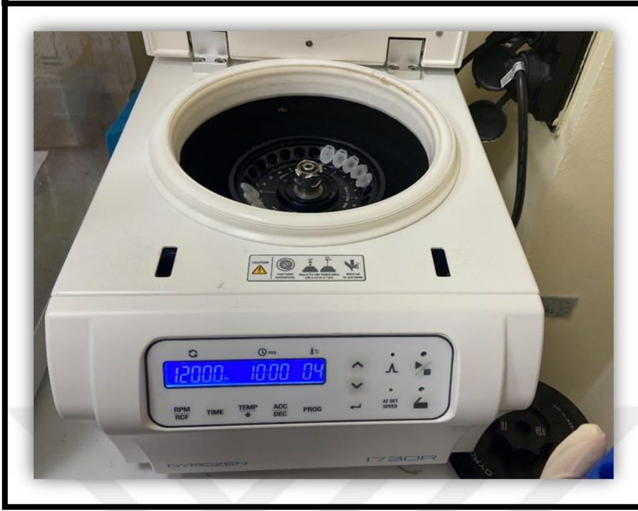
Şekil 3. 11: Numune örneklerini 3 ayrı faza ayırmak için 12000 x g'de 15 dakika santrifüj edilmesi (Gyrozen 416, Korea)
